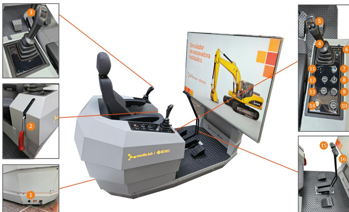
Figura 24: Distribución de los controles en el puesto.
