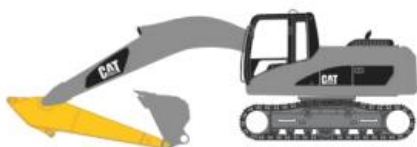
Stick: extensión del brazo que se conecta al extremo del “Boom” y sostiene el “Bucket”
