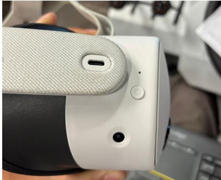
Figura 6: Puerto USB tipo C utilizado para carga y conexión del casco de realidad virtual.
