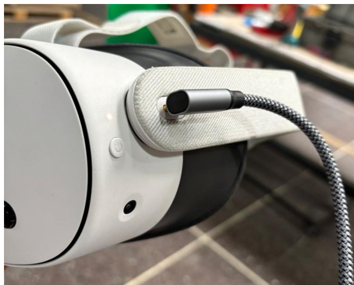
Figura 7: Cable de carga conectado al óculo
