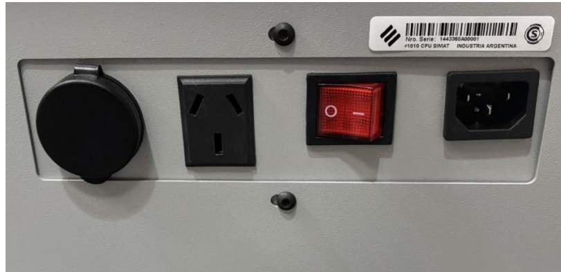
Figura 51: Panel de encendido y energizado.
