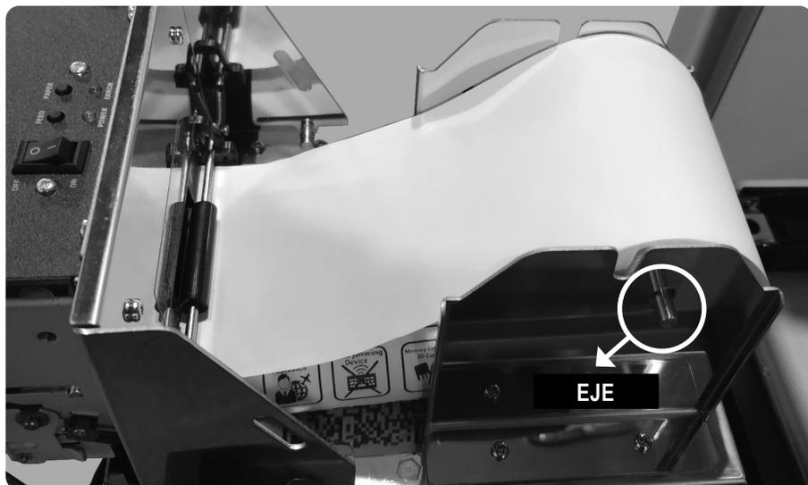
Una vez realizado el cambio de papel, vuelva a ingresar la impresora al interior de la terminal y verifique que la boquilla de la impresora coincida con la boca de la terminal para asegurar un correcto funcionamiento.
